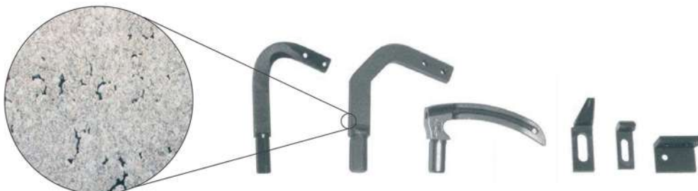
Material AISI 4317 magnificado 1:370
